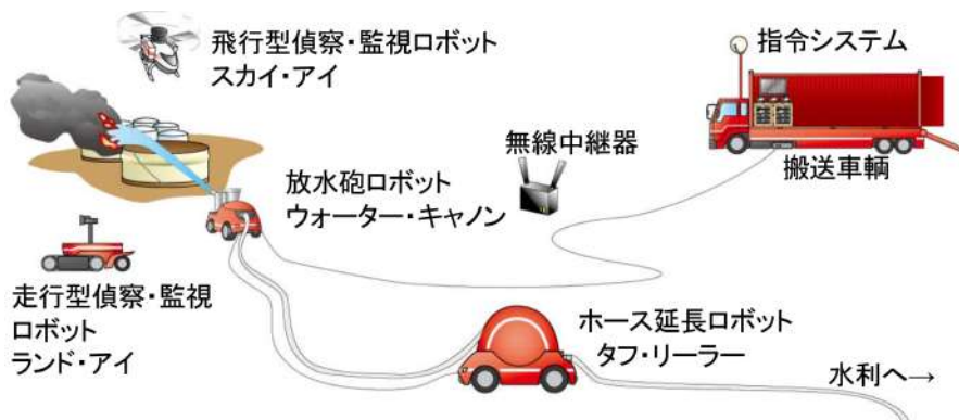
圖 11、消防無人載具系統 Scrum Force 示意圖[13]
